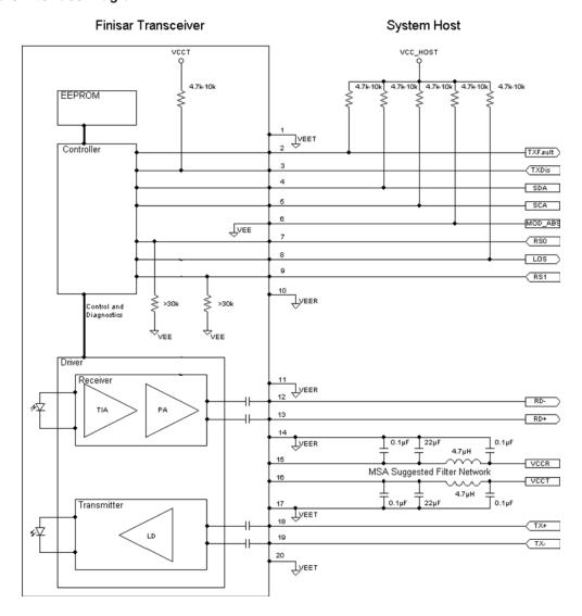
Figure 5. Host-Module Interface
