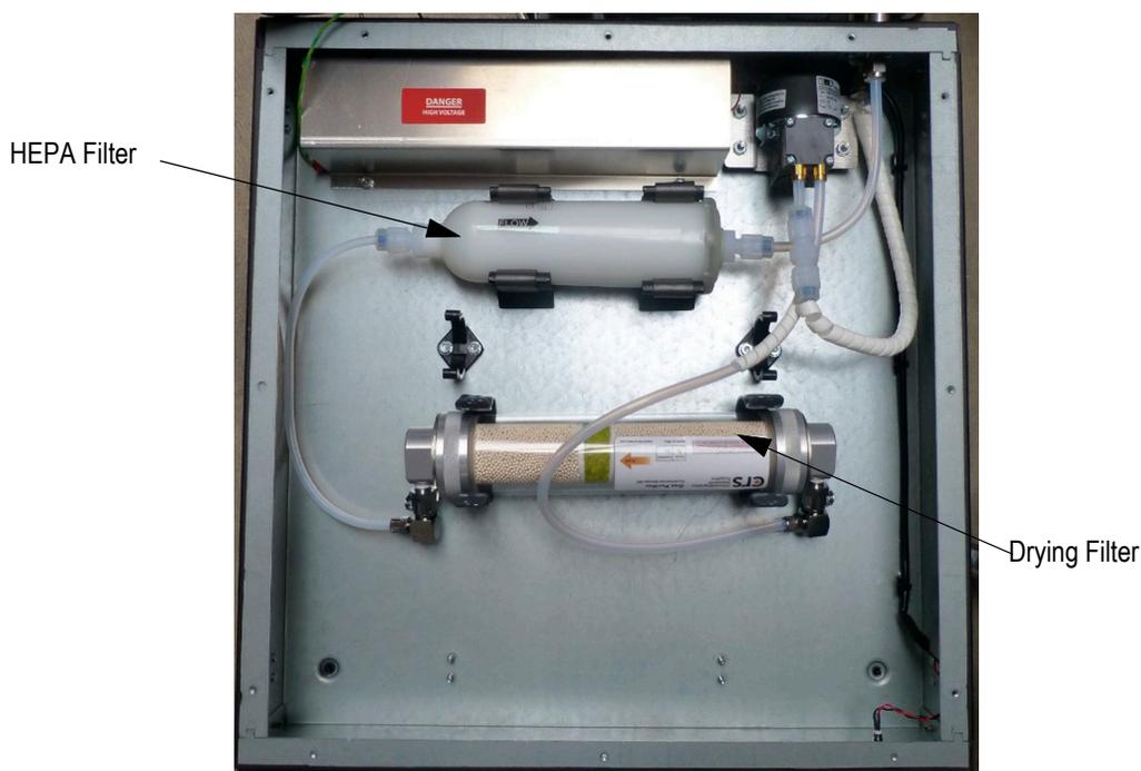
**Figure 10-7. MRU X1 Internal Components**
