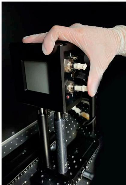
**Figure 9-3. Install Cap Plugs**
