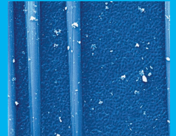
Nach Excimer-Ablation freiliegende und intakte Kohlefasern.
