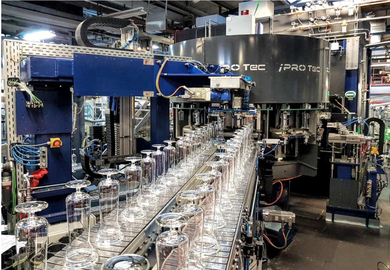
Bild 5: Das iPROtec-System ist eine vollautomatische Anlage zum Entfernen von Weinglaskappen mit SmartCleave bei einem Ausstoß von bis zu 80 Stück/Minute.
