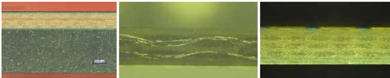
图 4: 使用 HyperRapid NX 皮秒激光器切割的不同 PCB 材料的横截面。左图: 包含金属层的 1.3mm SiP (使用 HyperRapid NX 绿光皮秒激光器, 切割速度大于 10mm/s)。中图: 陶瓷基板上 250µm 厚的 PCB “指纹传感器” (使用 HyperRapid NX 绿光皮秒激光器, 切割速度大于 40mm/s)。右图: 1mm 厚的 PCB (使用 HyperRapid NX 红外皮秒激光器, 切割速度大于 20mm/s)。
