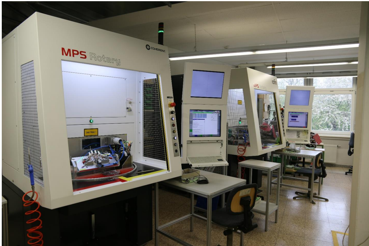
Bild 1: Zwei MPS Drehtelleranlagen zum Laserschweißen von Brillen in der Produktion bei Silhouette in Linz, Österreich
