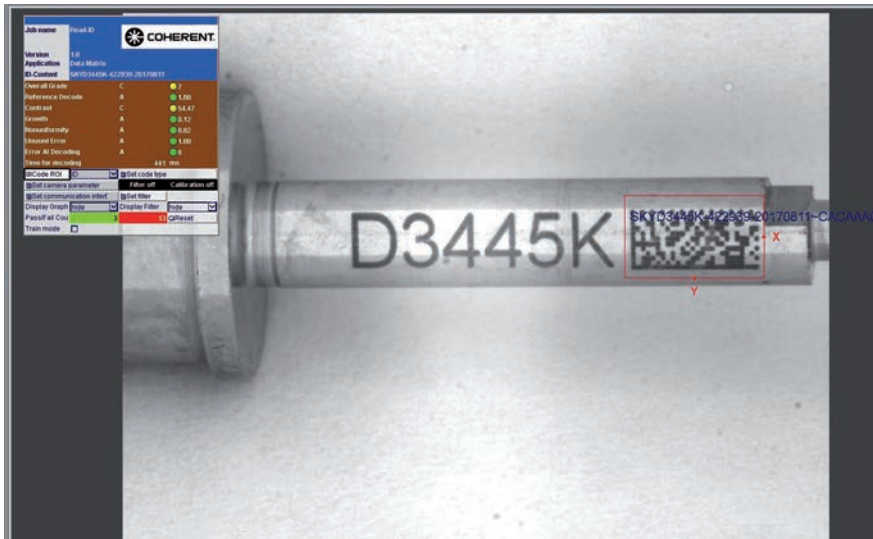
Bild 5: Dieses Bild zeigt eine UDI-Markierung nach 50 Autoklavierzyklen ohne signifikanten Einfluss auf die Lesbarkeit und ohne sichtbare Korrosion.
