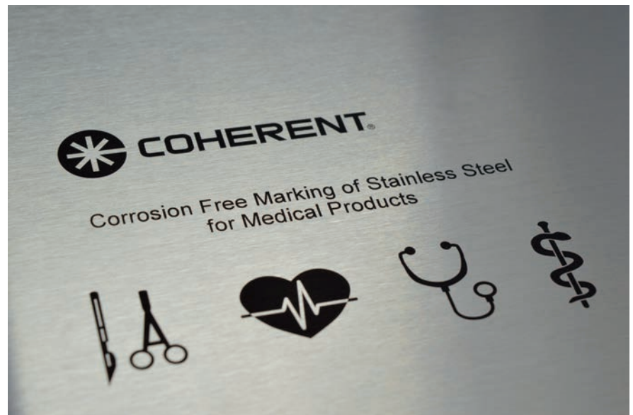
Bild 2: Die kurzen Pulse eines Pikosekundenlasers erzeugen eine Oberflächenstruktur, die Licht einfängt und das darunterliegende Material unbeeinflusst lässt.
