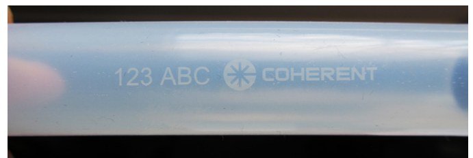
Bild 2. Ultraviolette Laser können farblose Materialien wie Silikon markieren ohne die äußere Oberfläche zu beeinträchtigen.
