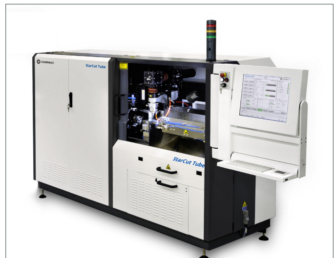
Abb. 2: Der StarCut Tube integriert zwei Lasertypen in einer einzigen kompakten Maschine.
