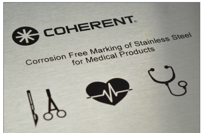
図2. ピコ秒レーザシステムによって、1.4301 (JIS: 304)のステンレス鋼上に作成した黒色マークの例。
