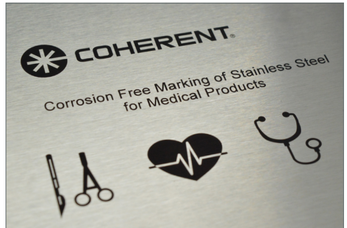
Bild 2. Die Schwarzmarkierung erzeugt kontrastreiche dauerhafte Markierungen in Edelstählen, wie z.B. 1.4301
